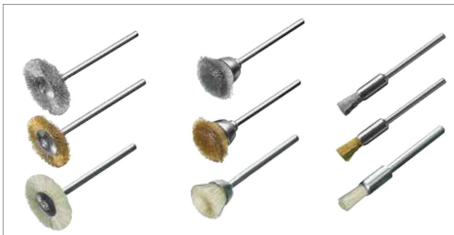
Les brosses miniatures sont adaptées au polissage, au nettoyage ou à l'ébavurage de petites surfaces ou de pièces. Les brosses miniatures peuvent être utilisées, par exemple, pour enlever les scories et les écailles des petits cordons de soudure et des joints soudés.
